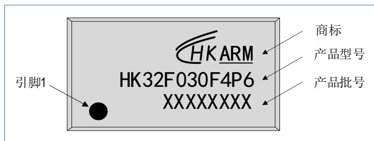
图 6-9 TSSOP20 HK32F030F4P6 丝印示例
