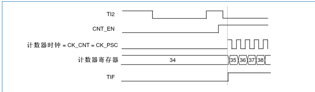
图 14-39 触发器模式下的控制电路
