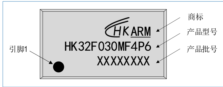
图 7-10 TSSOP20 HK32F030MF4P6 丝印示例
