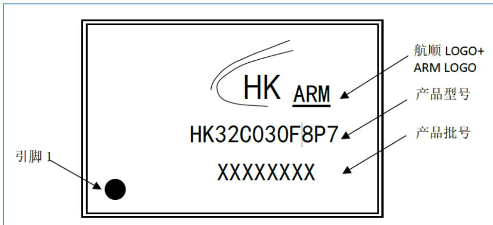
图 7-10 TSSOP20 丝印示例
