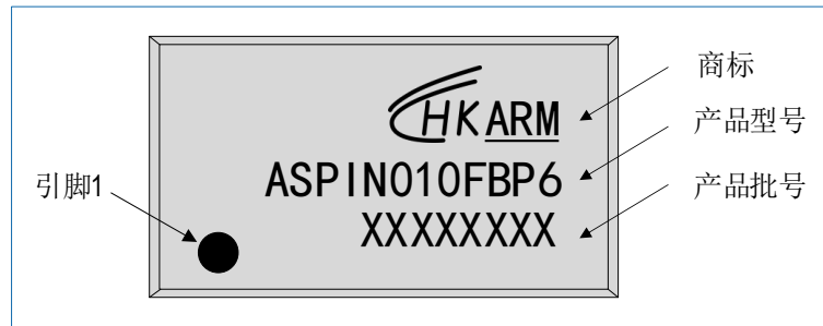
图 7-12 TSSOP20 HK32ASPIN010FBP6 丝印示例
