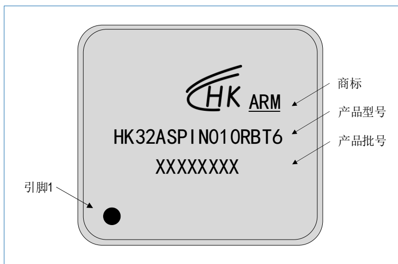
图 7-7 LQFP64 HK32ASPIN010RBT6 丝印示例
