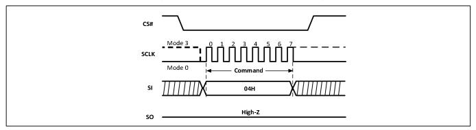
Figure-6. Write Disable Sequence Diagram (QPI)
